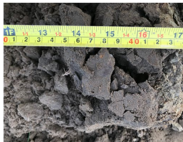
Structuur 25-50: Op 40 cm is een storende harde laag te zien. Deze laag zit vlak boven de overgang naar de zandlaag. De wortels hebben moeite om hier door heen te komen.
